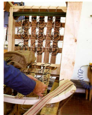
Particolare della lavorazione dell'imbottitura a molle Detail of the upholstery with steel springs Detail der Polsterung mit Spiralfederung
