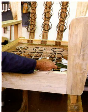
Particolare della lavorazione dell'imbottitura a molle Detail of the upholstery with steel springs Detail der Polsterung mit Spiralfederung
